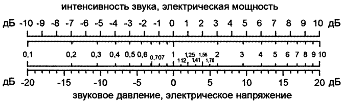
Рис. 1.1. Отношения амплитуд и уровней в абсолютных единицах и в децибелах
